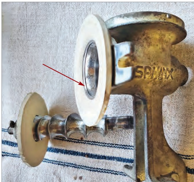
Na tele mlynčeka je na miesto pôvodného stojaceho mlecieho disku tromi skrutkami pripevnené plechové medzikružie, na ktoré bola potom nalepená 4mm hrubá potravinárska guma. Rovnako je gumou polepený aj pôvodný otočný mlecí disk.
