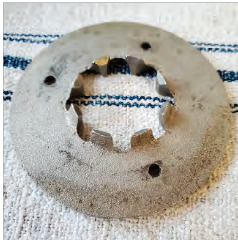
Pôvodný stojací mlecí disk svojimi výbežkami zužoval priestor v mechanizme mlynčeka a spôsoboval tým lámanie zŕn, aj pre zníženie celkovej hrúbky diskov s gumou som ho preto nahradil plechovým medzikružím, na ktoré bola po jeho priskrutkovaní na telo mlynčeka nalepená guma.
