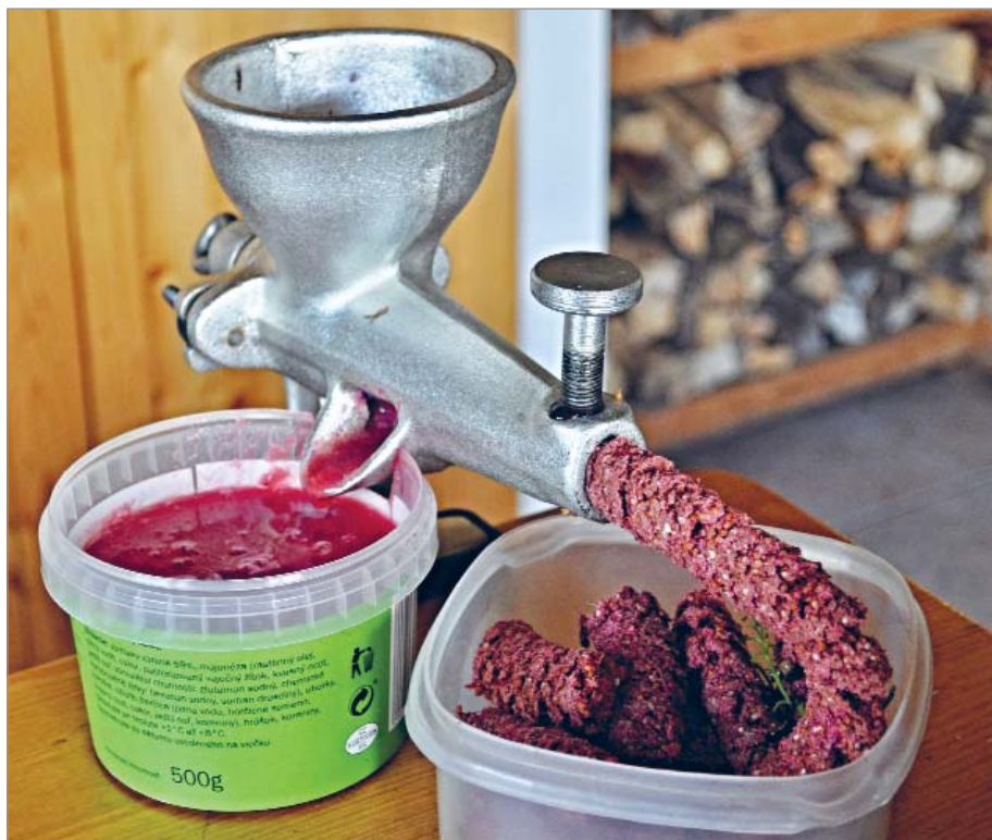
Odšťavňovač s kuželovým Archimédovým šroubem vytlačí průměrně 88 procent váhy sklizně jako hladkou dužninu na želé.
