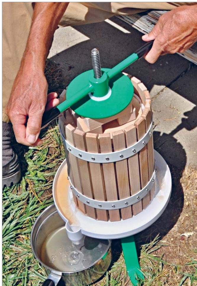
Ruční lis na ovoce vytlačí zhruba 60 procent váhy sklizně jako dost čistou šťávu.
