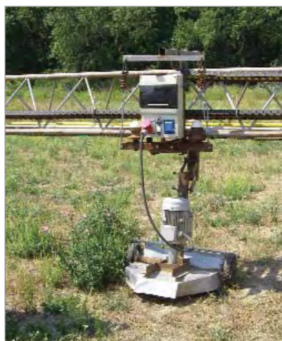
Na mostovém otáčejícím se rameni jsou zavěšeny menší stroje s vlastním pohonem. Vpravo rylovák. Po rameni se posouvají pomocí řetězu a ten umožňuje ladit pohyb otáčení ramene a posun stroje od kraje kruhu do jeho středu. Ovládání je už pomocí elektroniky.
