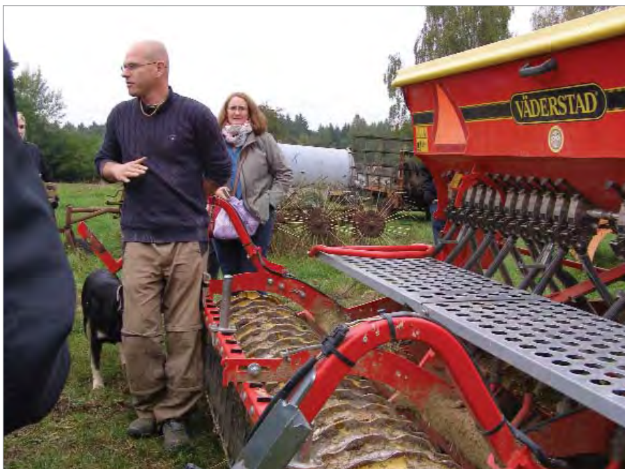
Diskový podmiítač se sečí skříne představuje ekozemědělcům pan Kratochvíl. Slouží k minimalizačnímu zpracování půdy.
