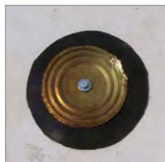
Otvory vany lze jednoduše uzavřít pomocí šroubu, gumy a víčka od konzervy.
