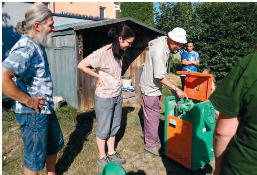
Loupačka na pluchaté pšenice špaldu a jednozrnku. Loupačka odstraní ze zrn pluchy a oloupané obilí je následně pomleto na mlýnku, mouka pak poslouží k upečení dobrého domácího chleba, který ochutnali i návštěvníci setkání.
