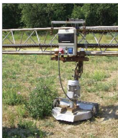
Na mostovém otáčejícím se rameni jsou zavěšeny menší stroje s vlastním pohonem. Vpravo rylovák. Po rameni se posouvají pomocí řetězu a ten umožňuje ladit pohyb stroje od kraje kruhu do jeho středu. Ovládání je už pomocí elektroniky.
