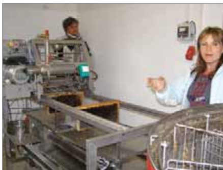
Odvíčkovací stroj a medomet a na něj navazující nádoby na med
